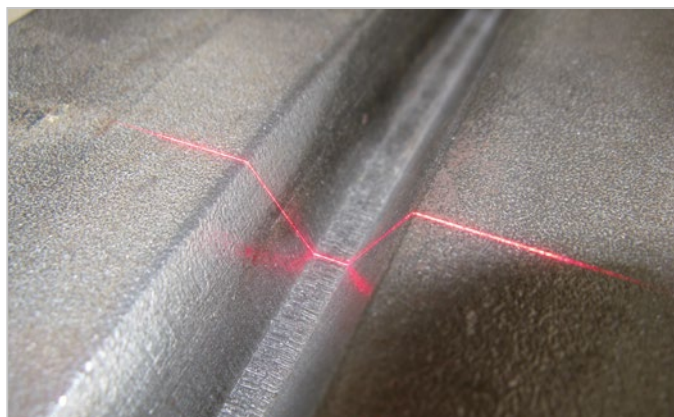
V-Naht-Messung an Rohren
