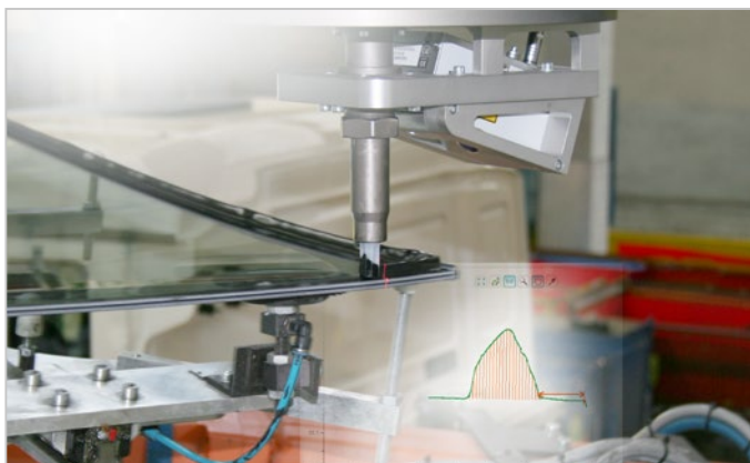
Prüfung des Kleberaupenauftrags
