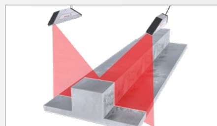
Geometrieprüfung in der Metallbearbeitung
