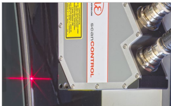
Spaltmessung an Fahrzeugkarossen
