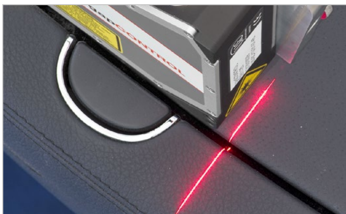
Abstandsmessung an der Mittelkonsole
